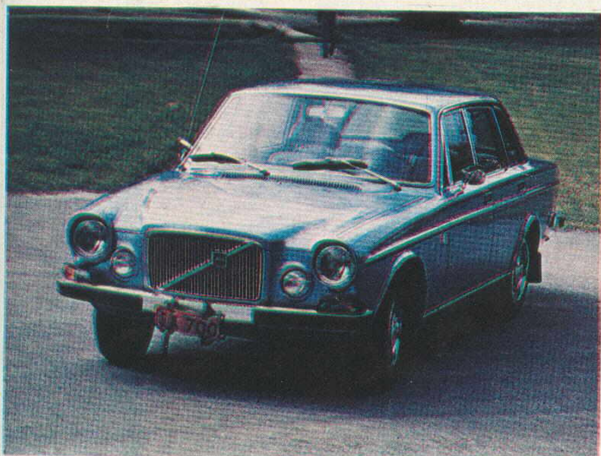
VAIKKA sivukuva muistuttaakin pienempiä Volvoja, näkyy ero sitäkin selvempänä keulan puolelta. Nelikulmainen säleikkö on uudessa vuosimallissa leventynyt ja kaikissa valonheittimissä on H4 lamput. Rengaskoko on kasvanut 175 HR 15:een.
