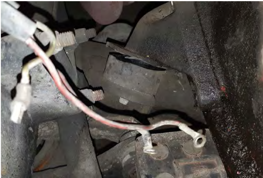
Upptäcker att höger motorkudde är trasig
