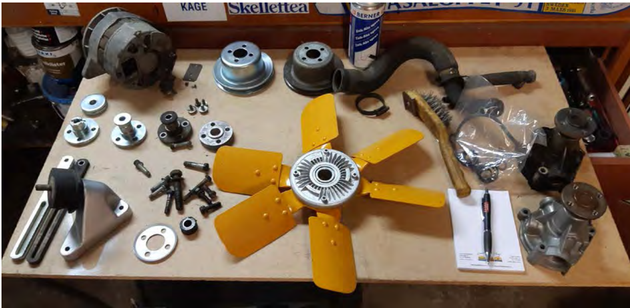
Ny vattenpump och uppmålad kylfläkt. Byte remskiva som är elförsinkad.
