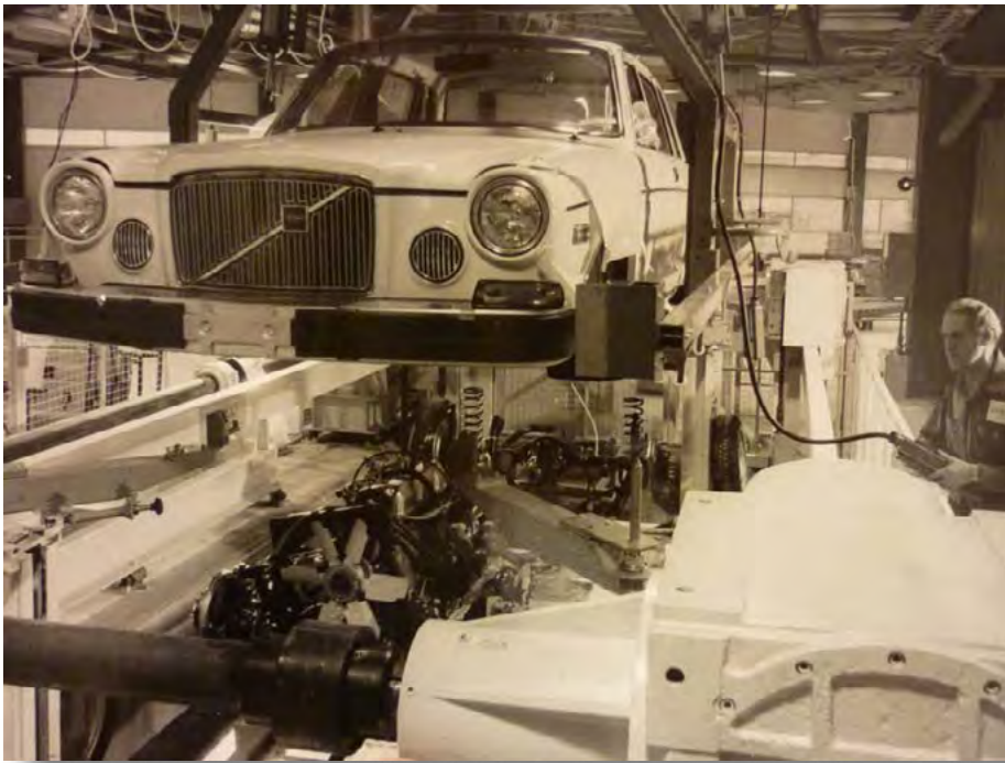
Marriage Point, karossen möter motor med drivlina
