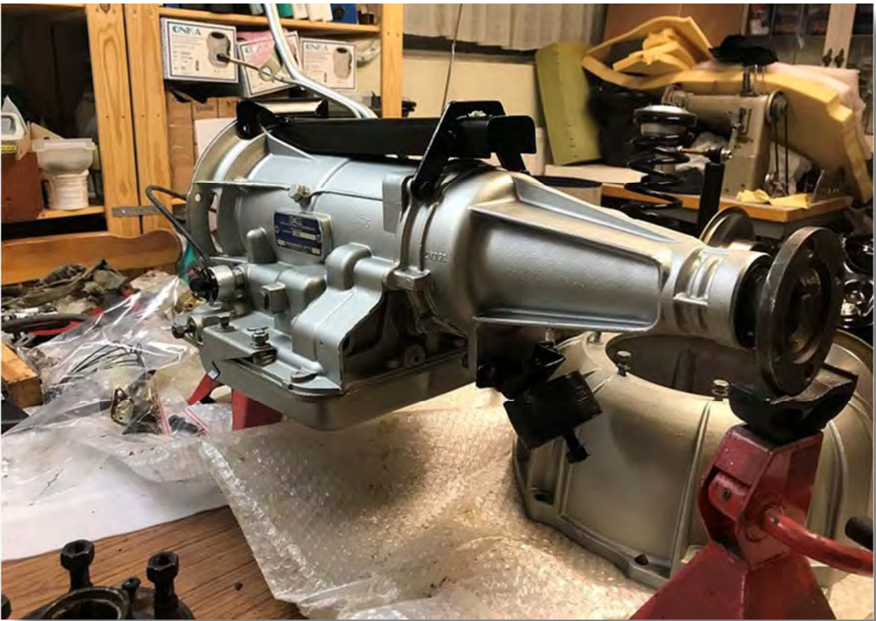
Växellådan är uppfixad med "Aluma Blast" utvändigt (ingen renovering invändigt).
