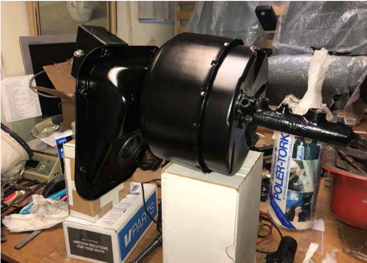
Bromsservo med pedalställ har fått tillbaka sin lyster.
