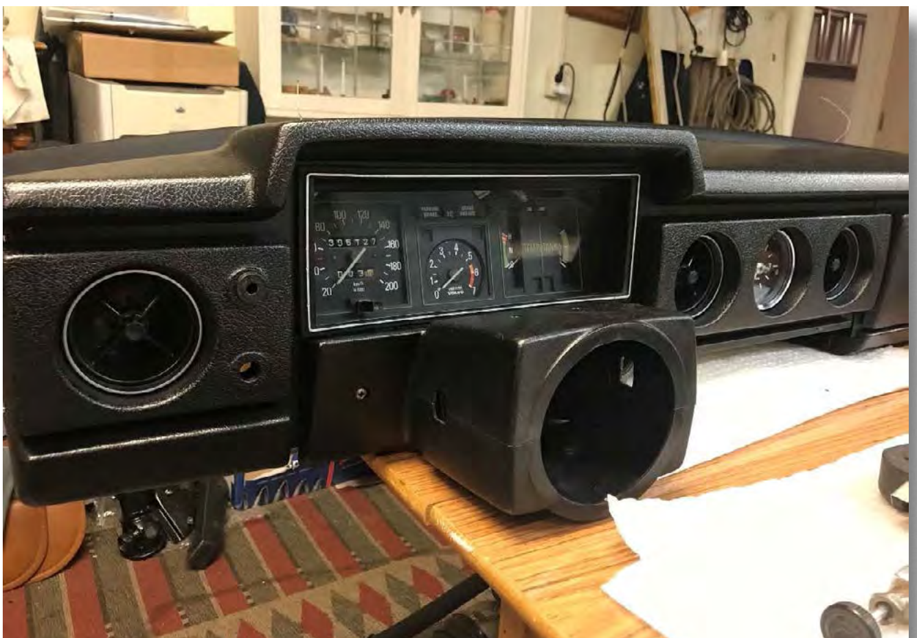
Instrumentpanelen är återställd med lack och puts.
