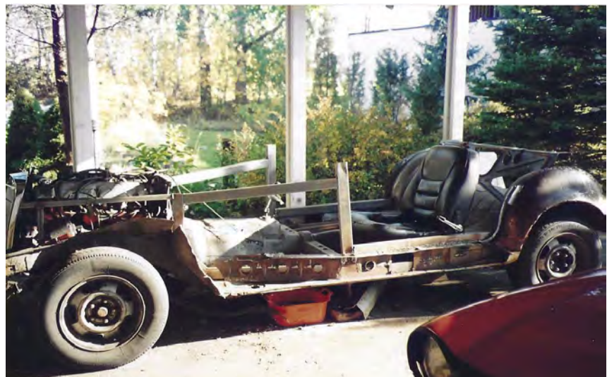
Nu är förstärkningen gjord och taket har kunnat kapas av.
